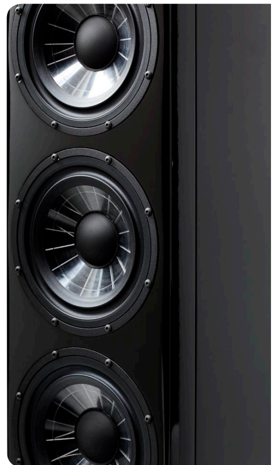
Die Tief- und Mitteltöner-Membrane aus Kunststoffgemisch weisen exakt positionierte, sich nach außen verjüngende Streben auf, die während der Membranherstellung aus dem Kunststoff ausgeformt werden. Diese so genannte „Spider Cone“-Technologie dient der zusätzlichen Versteifung der Membran
