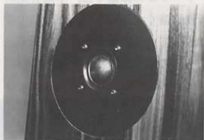
▲カスタムメイドのスクヤンスピーク社製3cmシルクドーム・ツイーター。パッフルへのマウントはシリコン材を介したフローティング構造で、振動の影響を低く抑えている。
