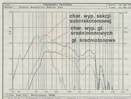
Rys. 2b - pomiar źródeł niskich częstotliwości sinusoidą w polu bliskim - charakterystyka wypadkowa sekcji sub-niskotonowej, głośniki średniotonowe, ich charakterystyka wypadkowa i charakterystyka wypadkowa wszystkich źródeł w zakresie niskich częstotliwości
